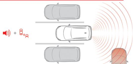
Détecte un véhicule s'approchant d'un côté ou de l'autre lorsque vous êtes en marche arrière. Le système vous alerte par des témoins clignotants dans les deux rétroviseurs extérieurs, une tonalité dans l'habitacle et un message d'avertissement au tableau de bord.
