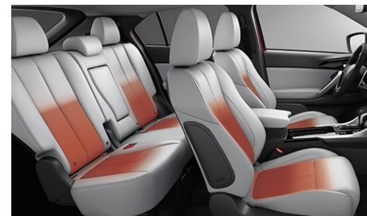
SIÈGES CHAUFFANTS À L'AVANT ET À L'ARRIÈRE
