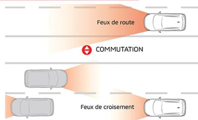
Détectent le niveau de luminosité des phares des véhicules en sens inverse et font passer les phares automatiquement entre les feux de croisement et les feux de route, une caractéristique de sécurité utile lors de la conduite sur des routes faiblement éclairées.
