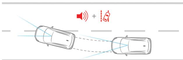
Utilise une caméra à bord pour surveiller la position de la trajectoire devant le véhicule et alerte au moyen d'un signal visuel et sonore lorsqu'il détecte que le véhicule quitte sa voie involontairement.
