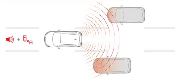
Vous avertis lorsqu'un véhicule se trouve dans votre angle mort ou s'en approche. Lorsqu'un véhicule dans la voie suivante circule à la même vitesse ou plus rapidement dans les zones de détection, un témoin d'avertissement s'allume dans le rétroviseur extérieur correspondant. Si vous actionnez le clignotant, le témoin d'avertissement du rétroviseur extérieur correspondant clignotera et le système émettra trois bips pour vous indiquer que vous ne pouvez changer de voie de manière sécuritaire.
