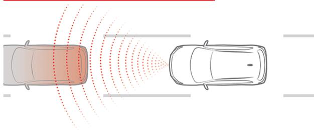
Utilise le radar pour ajuster automatiquement la vitesse de croisière du véhicule afin de maintenir une distance fixe entre vous et le véhicule devant.
